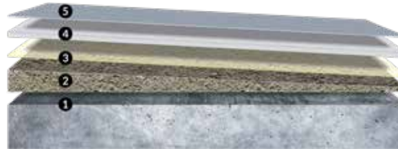
CUBIERTA TRANSITABLE SOBRE PENDIENTE
